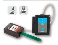
• Tento senzor měří obsah soli v roztoku ve třech rozsazích: %, mg/l, ppm.
